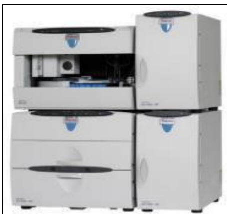
Figure 11 : Chromatographe ionique THERMO (Modèle ICS5000) utilisé pour l'analyse ionique des échantillons
