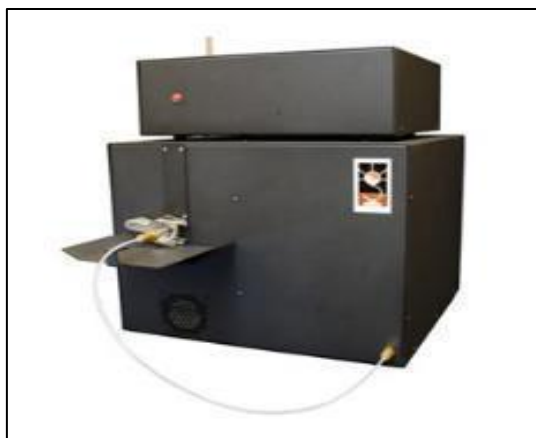
Figure 12 : Analyseur de carbone par méthode thermo-optique (instrument Sunset Lab) utilisé pour la mesure EC-OC des échantillons
