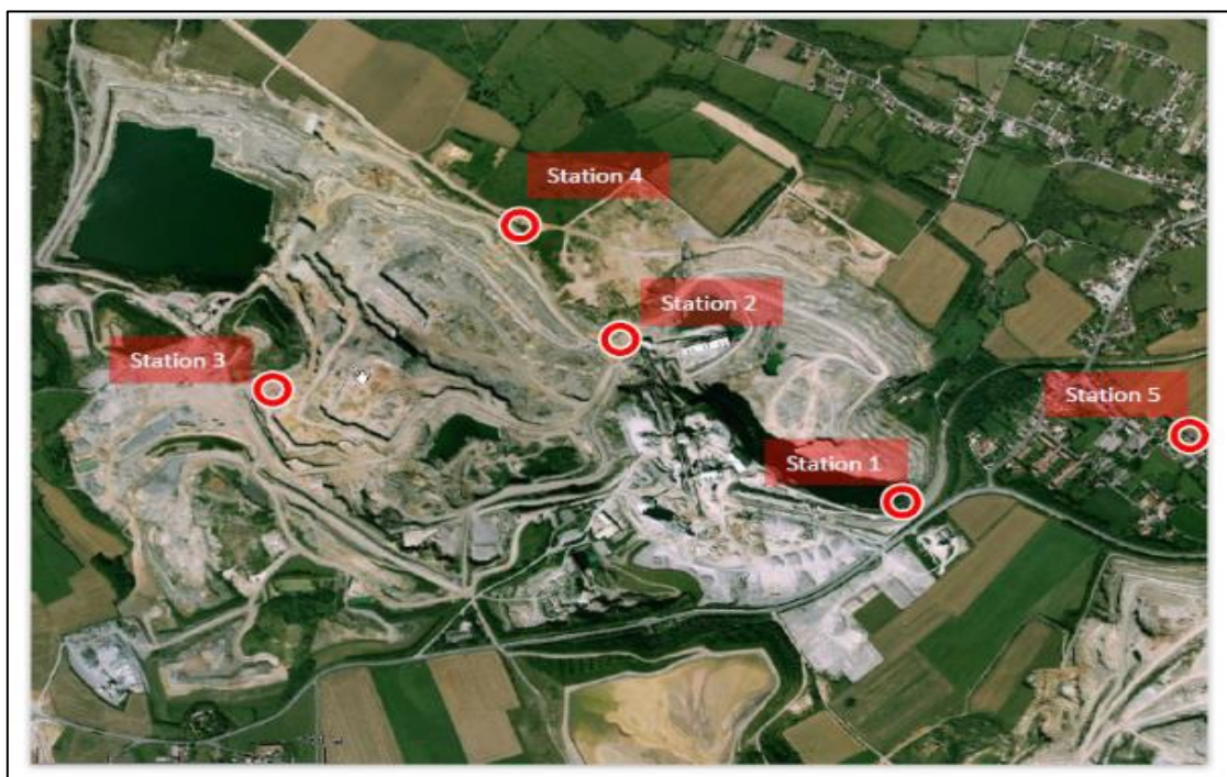
Figure 197 : Localisation des micro-capteurs sur la carrière B et en périphérie
