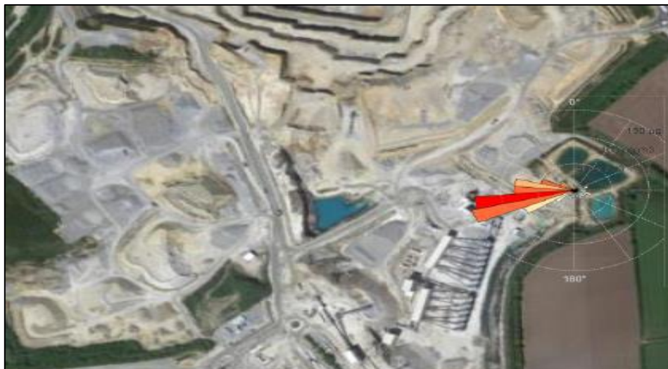
Figure 118 : Rose de pollution des PM10 au niveau du site mobile installé dans la carrière
