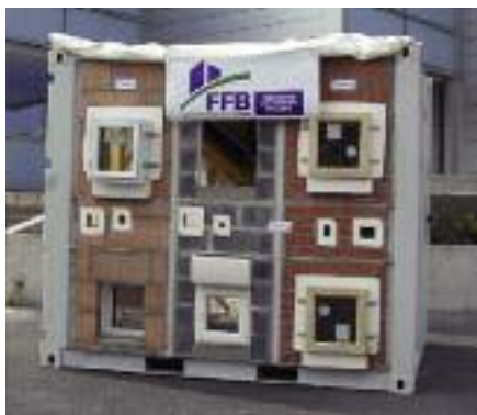
Plateforme Airpract - formation à l'étanchéité à l'air (source : FFB de Picardie)
