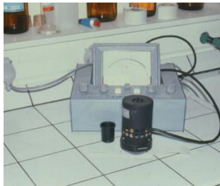
Réflectomètre utilisé pour la lecture des fumées noires
