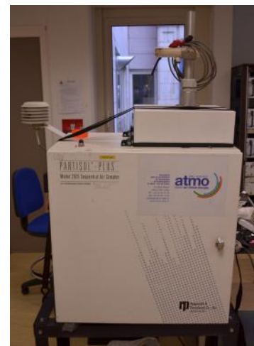
Partisol (préleveur de PM10 pour le prélèvement des métaux lourds)
